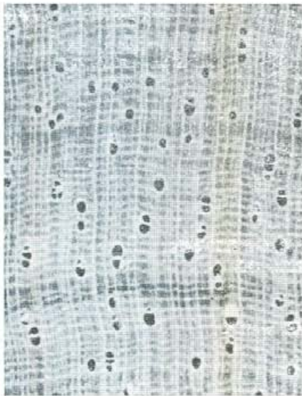
Fig. 4 — Aspecto macroscópico da madeira de Micrandra scleroxylon W. Rodr. n. sp., em seção transversal com 10X de aumento. (W. Rodrigues & A. Loureiro, 7065)
