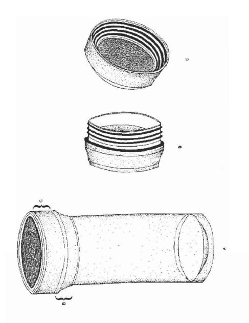
**Figura 1**. Ilustração da garrafa adaptada a realização dos testes com a cladócera *Moina micrura* "in situ, sendo mostrados: A — Conjunto completo; B — Fixador da tampa à garrafa; C — Tampa rosqueável com tela de plâncton.
